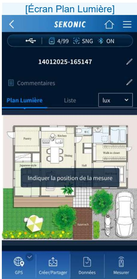
Si vous appuyez sur un emplacement à mesurer sur la configuration de l'éclairage, un point de repère orange est placé.
